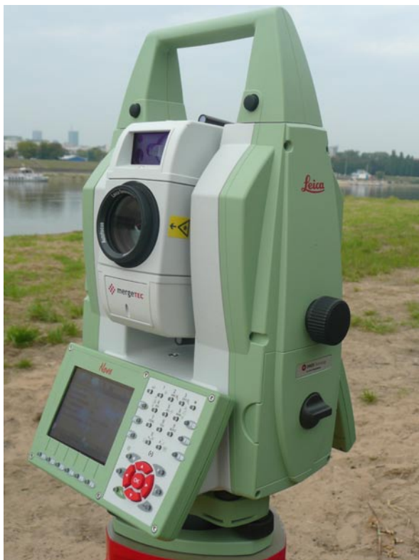
Fot. 2. Tachimetr skanujący wysokiej wydajności MS50 serii „Nova” (fot. K. Karsznia)
