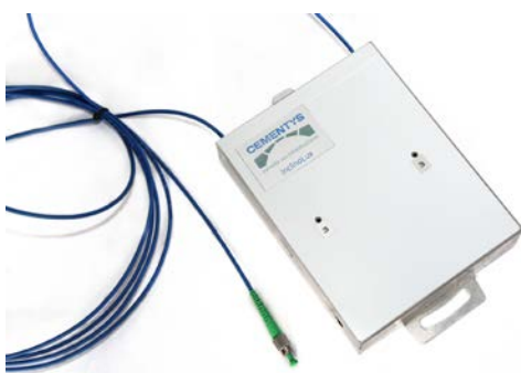
Widok linii światłowodowej wraz z przetwornikiem Cementys (z lewej) oraz jej praktyczna instalacja na obiekcie (z prawej)
